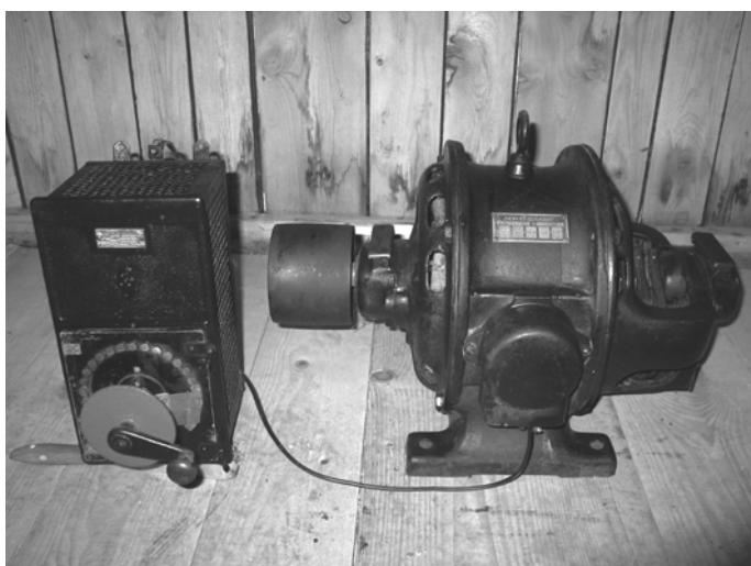
Schleifkolbenmotor mit Anlasser, zu besichtigen im Rohrdorfer Bauernhausmuseum
